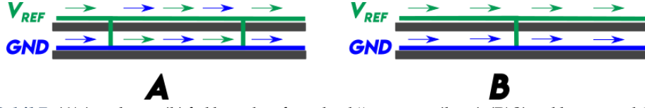
Şekil 7: (A) Aynı hattın iki farklı yerde referanslandığının gösterilmesi, (B) Sinyal hattının tek bir noktadan referanslanmasının gösterilmesi.
