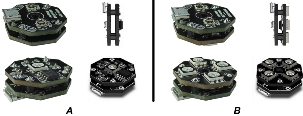
Şekil 2: MUA-B2N Modülünün Örnek Uygulamalarının Gösterilmesi. (A) RGB5VB-1FX ile. (B) RGB5VB-4FX ile.
